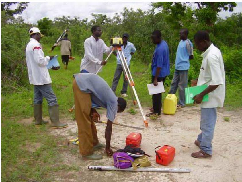
Fin août les volontaires de la Cellule Aménagement Foncier (CAF) de la FPG ont reçu une formation en topographie. Un apprentissage pour certains, un perfectionnement pour d'autres, sur l'utilisation de nos appareils : niveaux optiques et laser, GPS, théodolite.
