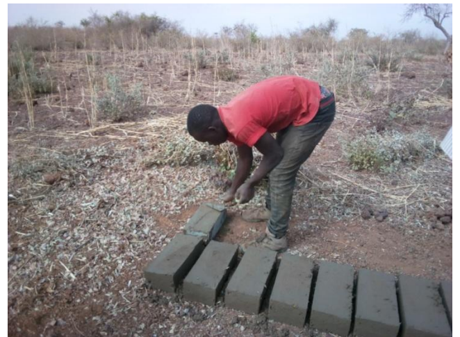
Figure 16: confection des briques pleines en ciment
