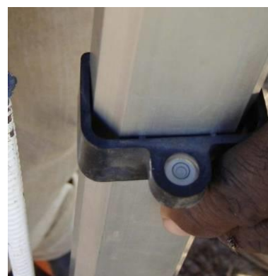
Photo 5 : niveau circulaire au dos de la mire
