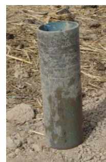
Photo 16 : gabarit pour les trous de piquets
